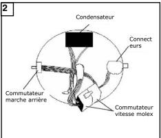
Vue du haut de la plaque du boîtier d'interrupteur.
