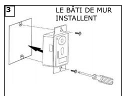
Reliez l'interrupteur de commande murale à la boîte de sortie de courant à l'aide des vis mécaniques fournis à cet effet.
