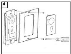
Attachez le couvercle d'interrupteur avant à l'interrupteur de commande murale à l'aide des vis fournis à cet effet.
