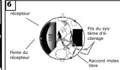
Aligner la fente du récepteur sur la vis entre la commande de vitesse et le commutateur d'inversion de direction et faire glisser le récepteur dans la plaque du boîtier d'interrupteur avec le commutateur DIP faisant face à la plaque du boîtier d'interrupteur. Le récepteur doit se nicher directement dans la zone de la plaque. Remarque. – En cas d'installation d'un système d'éclairage, utiliser les fils bleu et blanc du récepteur.
