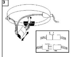
Déconnecter les raccords molex dans la plaque du boîtier d'interrupteur en appuyant sur l'onglet et en séparant les deux raccords molex.
